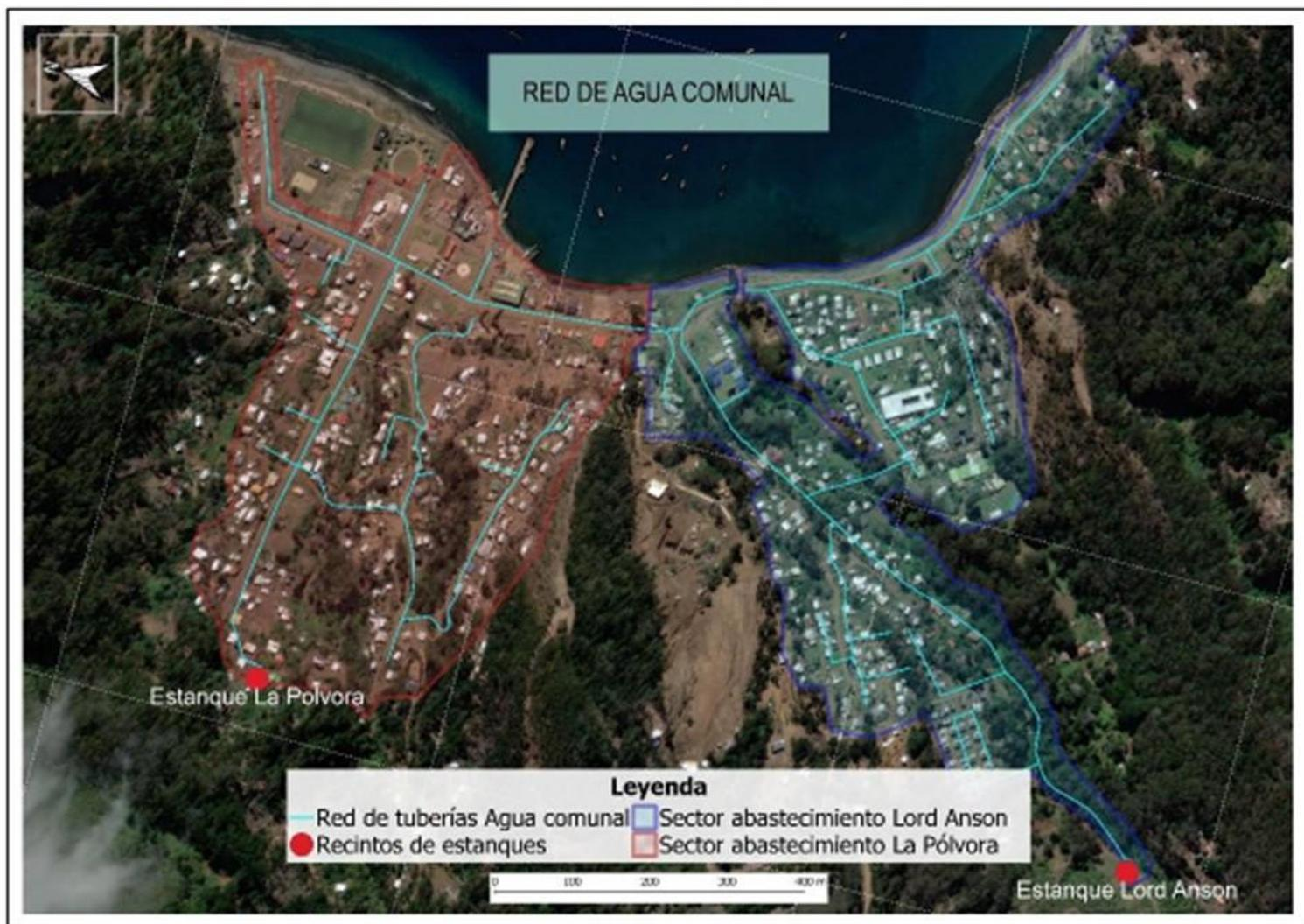
El sistema La Pólvara (oeste) abastece un total aproximado de 218 arranques, mientras que el sistema Lord Anson (este) abastece un total, también aproximado, de 270 arranques. Debido a que, entre ambos sistemas, sólo se cuenta con 9 válvulas de corte (4 en La Pólvara y 5 en Lord Anson), ante la eventualidad de reparaciones en la red muchos usuarios quedan sin suministro<sup>139</sup>.
